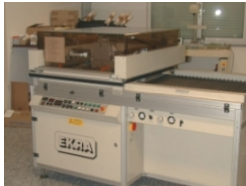
Bild 2: Siebdruckmaschine, Faber Electronics BV, Velp.
